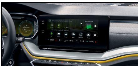
RADIO BOLERO 10" Ekran dotykowy, 2 gniazda USB-C umożliwiające ładowanie i transfer danych
