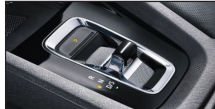
SHIFT-BY-WIRE Elektroniczne sterowanie automatyczną skrzynią biegów DSG
