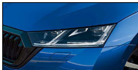
REFLEKTORY LED TOP MATRIX Doskonała widoczność, bez oślepiania innych uczestników ruchu drogowego
